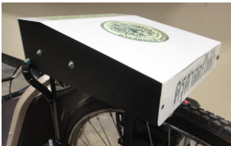
ภาพที่ 3-51 ติดตั้งกล่องควบคุม
