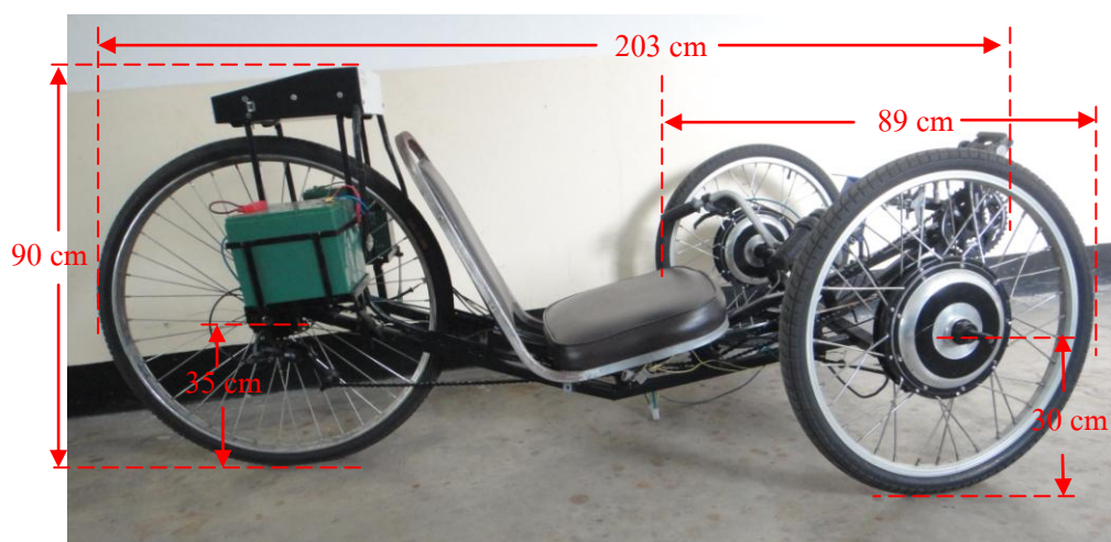
ภาพที่ ก - 2 แสดงขนาดต่างๆ ของรถจักรยานไฟฟ้า
