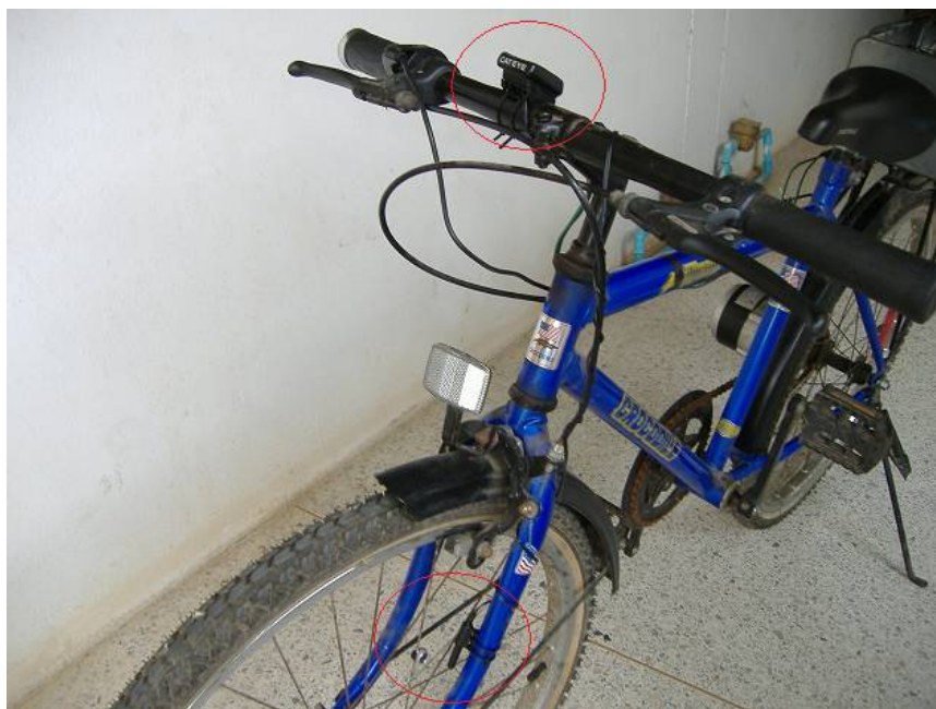
รูปที่ 3-19 รูปแสดงการติดตั้งอุปกรณ์วัดความเร็วเพื่อทดสอบแบบใช้งานจริง
