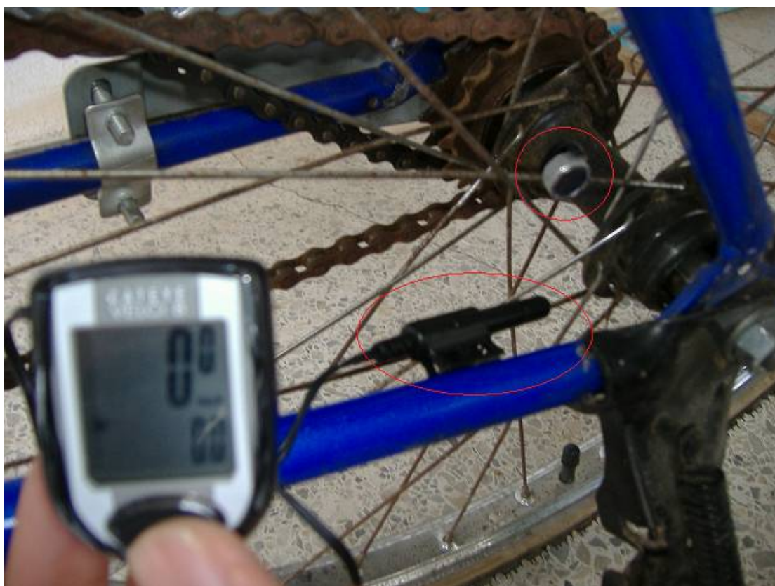
รูปที่ 3-18 รูปแสดงการติดตั้งอุปกรณ์วัดความเร็วที่ล้อหลังเพื่อทดสอบความเร็วที่สภาวะ No Load
