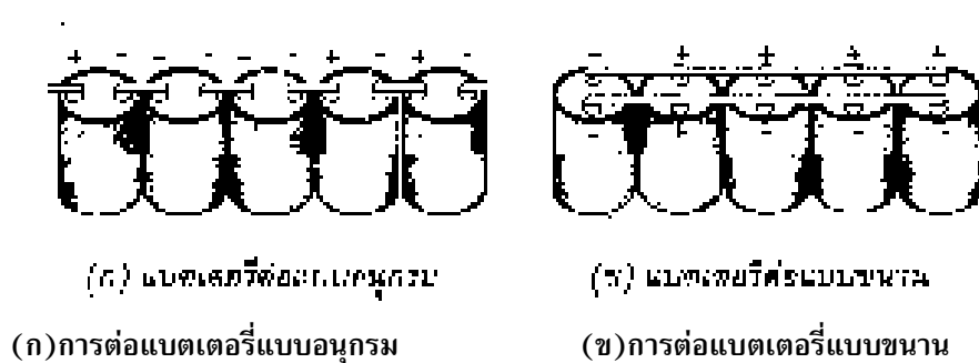
รูปที่ 2-32 แสดงการต่อแบตเตอรี่แบบอนุกรมและแบบขนาน
